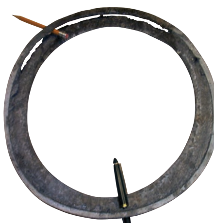
Corte casi completo alrededor de la junta en el DE de la cara elevada debido a sobreapriete severo (rotación de la brida).
