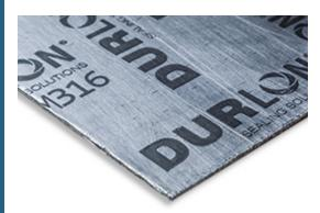
FGM316: Lámina con inhibidor hecha con múl-tiples capas de núcleo de hojas de acero inoxidable 316 de 0,004" de espesor. Se usa en aplicaciones con alta tensión mecánica o presión, resistencia al estallido superior a la media, rigidez excepcional y es apta para cortar juntas con tramos estrechos.
