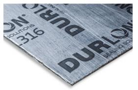
FGL316: Lámina de grado industrial estándar laminada con una unión adhesiva en ambos lados de un núcleo de hoja de acero inoxidable 316 de 0.002" de espesor. Se utiliza cuando un alto rendimiento y la manipulación son importantes.
