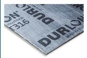
FGT316: Lámina de grado industrial estándar unida mecánicamente en ambos lados de un núcleo de espiga de acero inoxidable 316 de 0,004" de espesor. Se utiliza cuando las tensiones y presiones son altas y cuando es importante una mejor manipulación.
