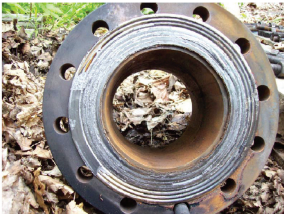
Junta después de la prueba - Final de 30 minutos de combustión y 10 minutos de enfriamiento
