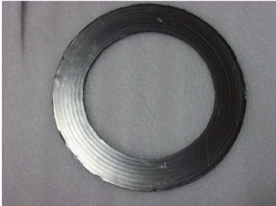
Muestra de la junta antes de la prueba - 6 pulgadas Clase 300 Junta Durlon® Durtec®
